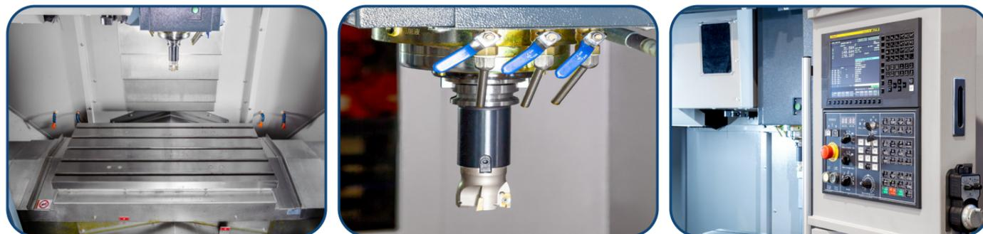
La **Serie VMC** comprende macchine di varie taglie, tutte equipaggiate con mandrino con attacco utensile tipo BT40 e magazzino utensili 16/24 posti. Possono essere fornite con CNC Fanuc o Siemens e prevedono di serie l'impianto per gestione fluido refrigerante esterno e conveyor per evacuazione truciolo.
